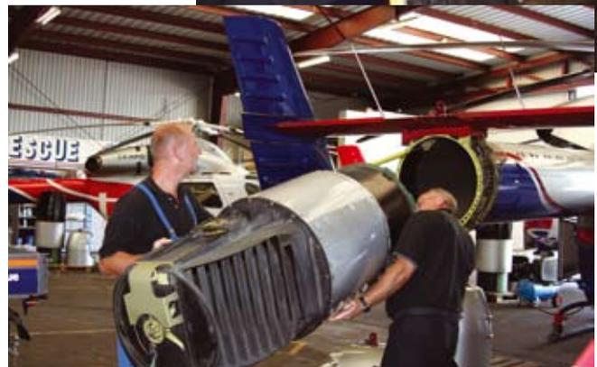
Verschiedene Modifikationen am Steuersystem sorgen für mehr Sicherheit und verhindern Haarrissbildungen an entscheidenden Bauteilen. Abschließend kann der Heckrotor wieder montiert werden.
