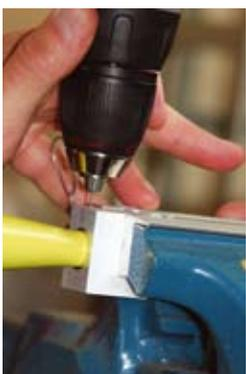
Mit einem Spezialbohrer wurde die weiterführende Teleskopstange durchbohrt und eine zusätzlich Seilsicherung eingebaut.
