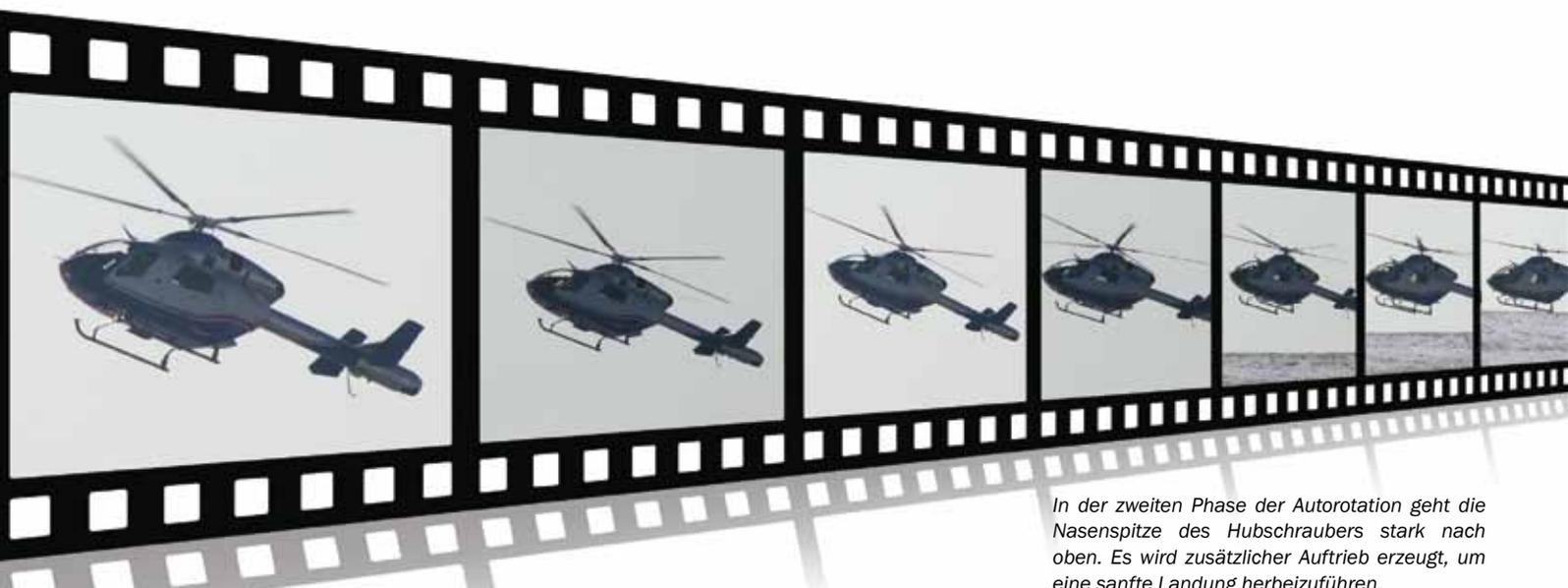
*In der zweiten Phase der Autorotation geht die Nasenspitze des Hubschraubers stark nach oben. Es wird zusätzlicher Auftrieb erzeugt, um eine sanfte Landung herbeizuführen.*
