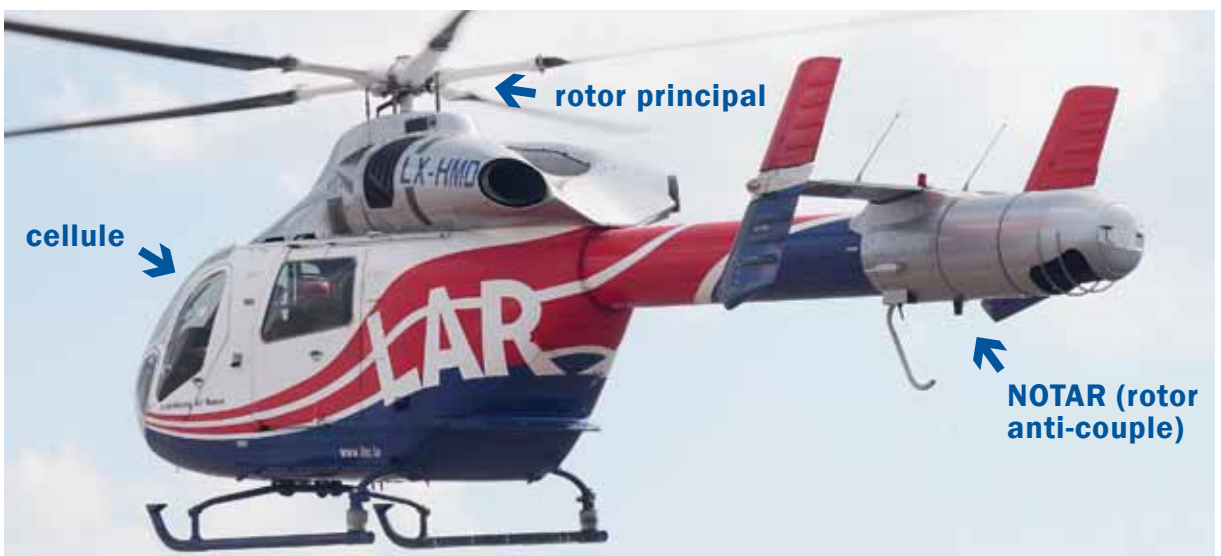
Les différents éléments de l'hélicoptère
