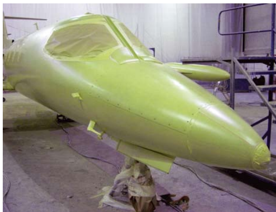
Eine spezielle Grundierung auf der Außenhaut sorgt für die optimale Haftung der Lackierung
