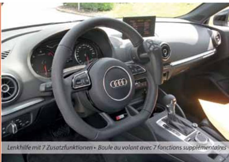
Lenkhilfe mit 7 Zusatzfunktionen • Boule au volant avec 7 fonctions supplémentaires
