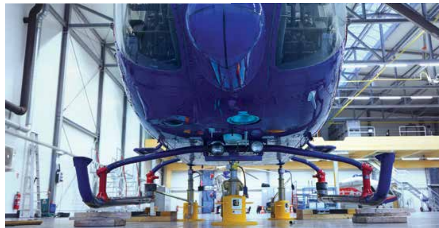
Der Hubschrauber wird von Hydraulik-Stempeln an drei bestimmten Punkten hochgebockt und gemessen, ähnlich wie ein Auto mit einem Wagenheber.
